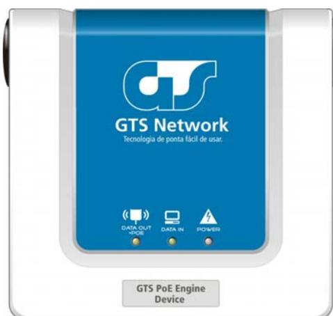
**LED Power:** Esse LED acende automaticamente quando o PoE é conectado a tomada elétrica.
