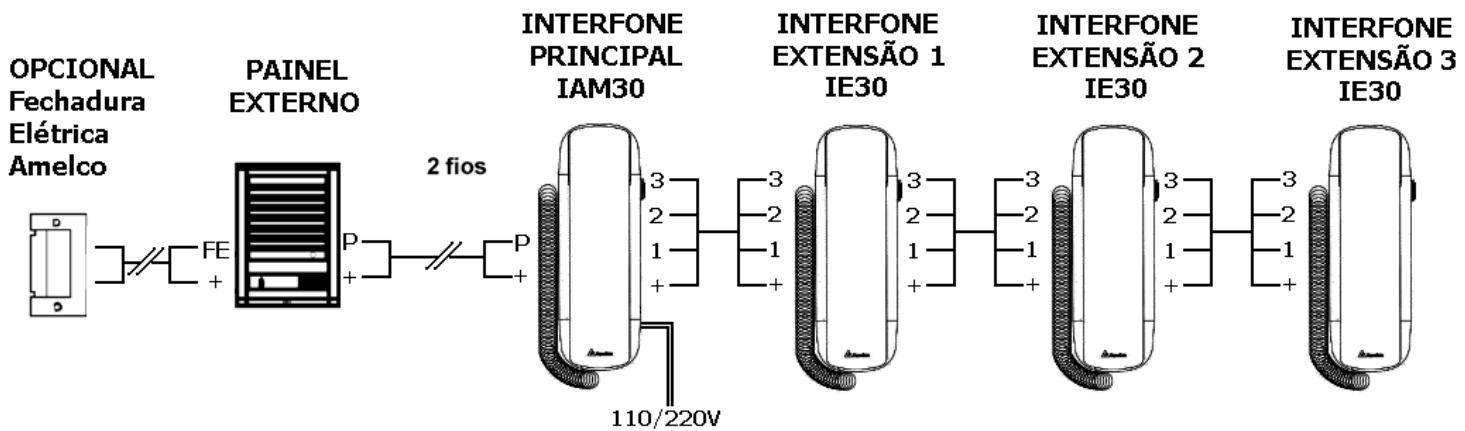
Para não ter toque em qualquer extensão (um ponto ou mais), basta não interligar o terminal "2". Para diminuir o volume do toque, basta cortar o resistor J1 do circuito, conforme indicado na figura abaixo.
