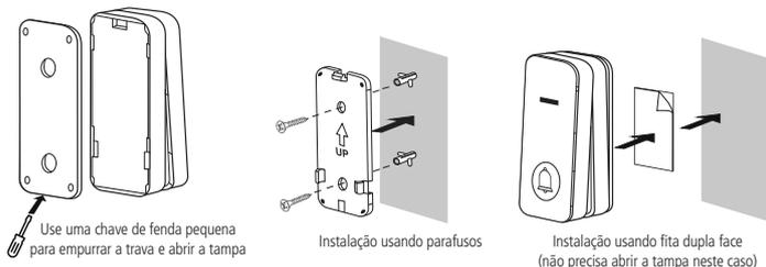
**Obs.:** para a correta fixação do módulo externo quando utilizada a fita dupla face, a superfície deve estar limpa, isenta de substâncias gordurosas, poeira ou qualquer tipo de contaminação que possa comprometer a fixação da cola.
