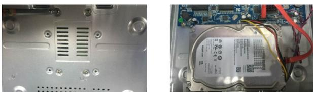
**Dicas:** Verifique a estrutura interna do NVR e verifique se os cabos estão bem conectados antes de instalar a tampa traseira.
