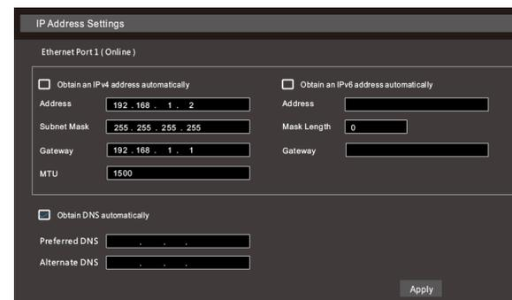
3. Vá para Iniciar → Configurações → Câmera → Adicionar Câmera. O NVR/DVR atualizará automaticamente as câmeras. A câmera IP suporta o protocolo Onvif e pode ser adicionada manualmente. Se a câmera IP pesquisada não estiver na mesma rede local que o NVR/DVR, você deverá selecionar o dispositivo e clicar no ícone "imagem" para modificar o endereço IP.
