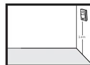
Fixe o sensor numa altura de 2.4 metros aproximadamente. Não fixe o sensor em divisórias que vibrem ou balancem
