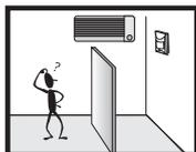
Não coloque o sensor olhando diretamente para ar condicionado ou local com circulação de ar. Não coloque obstáculos em frente ao sensor.
