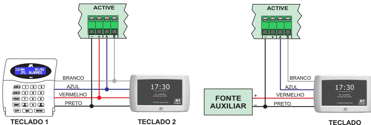
Obs.: -Usar bitola mínima da fiação AWG26 (0,2mm) para até 25m de cabo ou bitola mínima da fiação AWG24 para até 100m de cabo.
