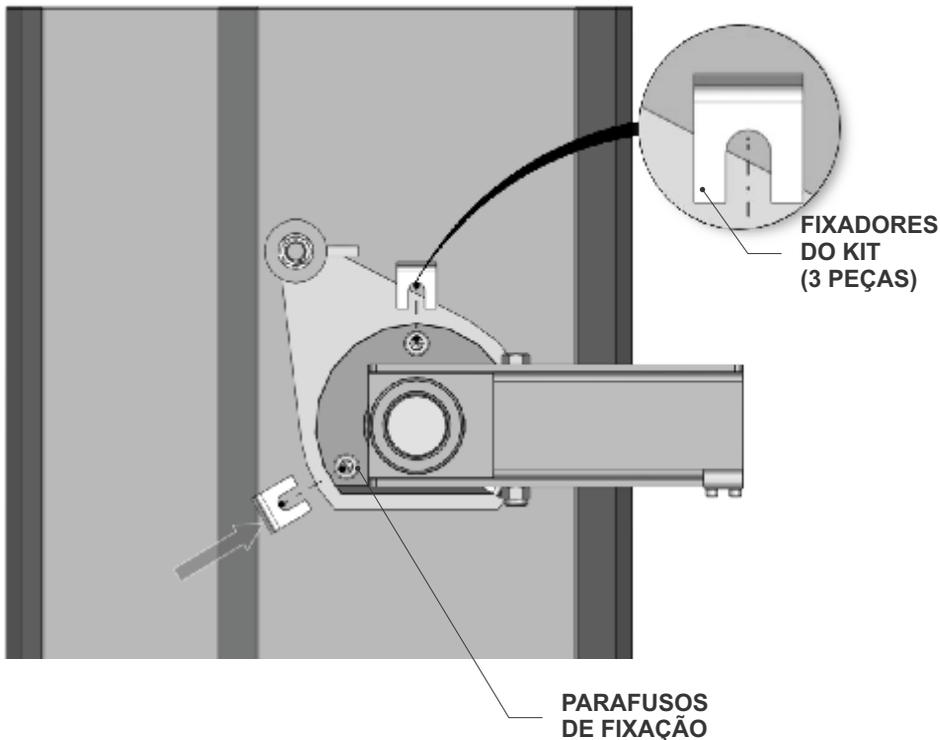
5º PASSO: RETIRAR OS FRISOS DE BORRACHA DO BRAÇO SE ESTIVER APLICADO, FIXAR O CONJUNTO ARTICULADOR ATRAVÉS DOS 4 PARAFUSOS QUE ACOMPANHAM O KIT, CONFORME DEMONSTRADO ABAIXO:
