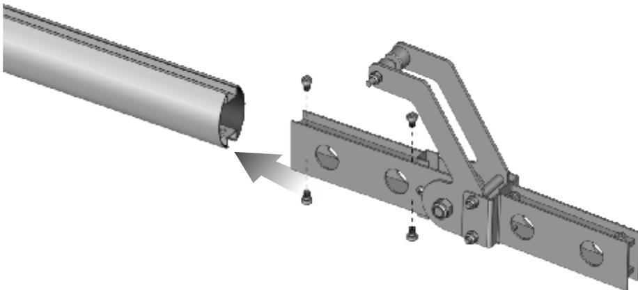
APÓS ENCAIXAR O CONJUNTO ARTICULADOR, ENCAIXE OS FRISOS DE BORRACHA NO PERFIL DO BRAÇO DESLIZANDO-O DENTRO DO SULCO DE ENCAIXE, CONFORME DEMONSTRADO ABAIXO:
