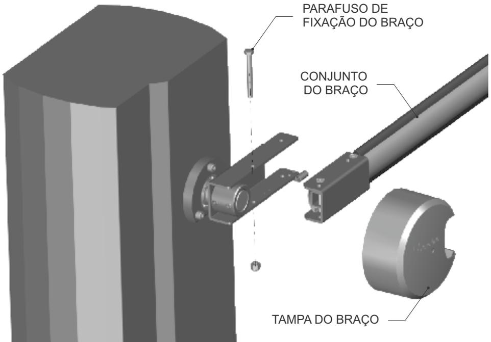
3º PASSO: SEGURANDO COM AS DUAS MÃOS, PASSE O SUPORTE DO KIT ATRAVÉS DO SUPORTE DO BRAÇO CONFORME DEMONSTRADO ABAIXO:
