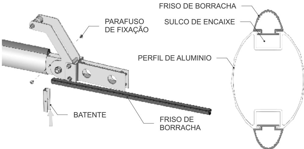
APÓS ENCAIXAR OS FRISOS, FIXE O BATENTE QUE ACOMPANHA O KIT UTILIZANDO OS DOIS PARAFUSOS CONFORME INDICADO ACIMA.
