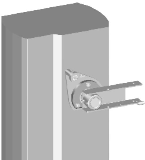
4º PASSO: SOLTE UM POUCO OS TRÊS PARAFUSOS QUE FIXAM O MANCAL DE ALUMÍNIO, INSIRA OS FIXADORES DO SUPORTE E APERTE OS PARAFUSOS NOVAMENTE. CONFORME DEMONSTRADO ABAIXO:
