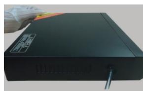
6. Volte a colocar a tampa e fixe-a com os parafusos.
