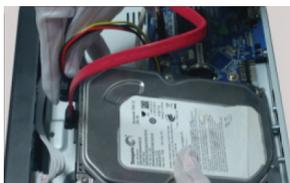
3. Coloque o HDD na parte inferior do dispositivo.
